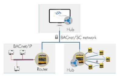
Mit BACnet/SC-fähiger Software und Hardware von SAUTER können bestehende BACnet-Installationen verschlüsselt werden.
