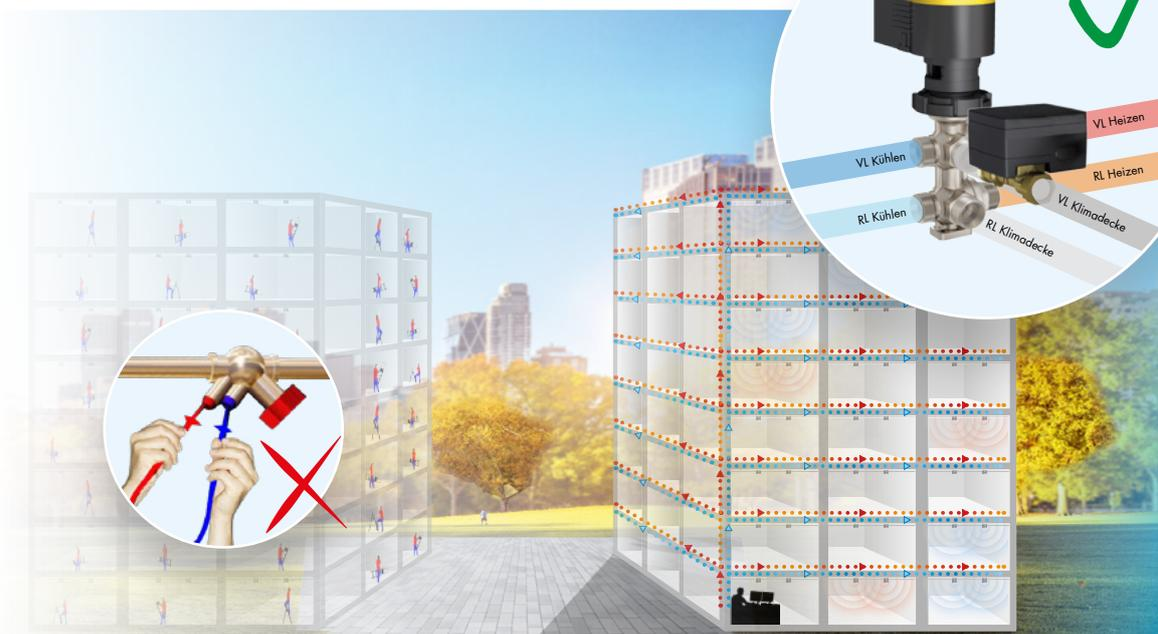
Konventionelle Drucküberprüfung und hydraulischer Abgleich: manuell und separat in jedem Raum.
