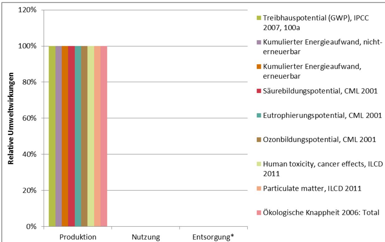
Das Ventil wird in Kombination mit einem Ventilantrieb als Stellgerät eingesetzt. Die vorliegende Ökobilanzierung umfasst die Umweltwirkungen der Herstellung und Entsorgung des Ventils. Umweltwirkungen des Antriebes inklusive dessen Energiebedarf werden separat erfasst und ausgewertet.
